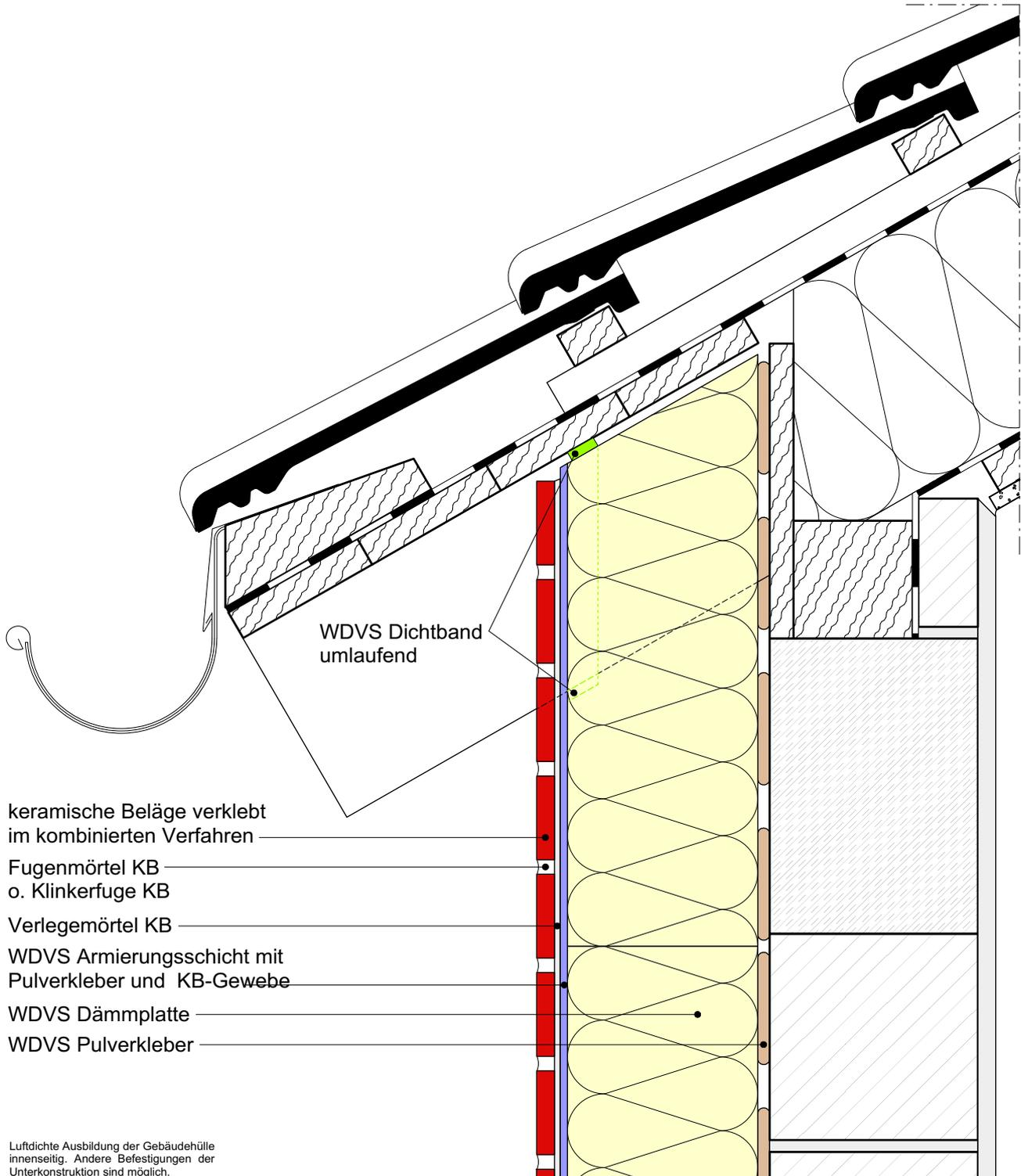
Luftdichte Ausbildung der Gebäudehülle innenseitig. Andere Befestigungen der Unterkonstruktion sind möglich.
