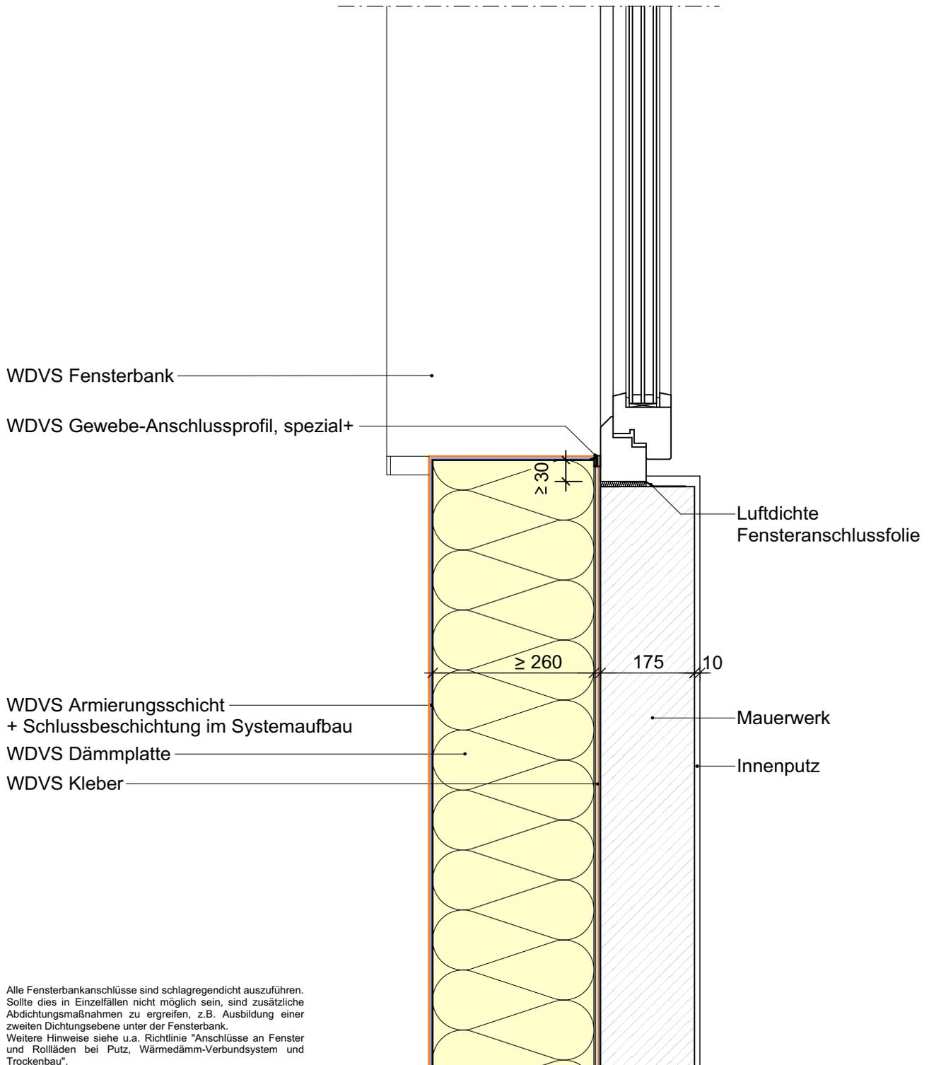
Alle Fensterbankanschlüsse sind schlagregendicht auszuführen. Sollte dies in Einzelfällen nicht möglich sein, sind zusätzliche Abdichtungsmaßnahmen zu ergreifen, z.B. Ausbildung einer zweiten Dichtungsebene unter der Fensterbank. Weitere Hinweise siehe u.a. Richtlinie "Anschlüsse an Fenster und Rolläden bei Putz, Wärmedämm-Verbundsystem und Trockenbau".
