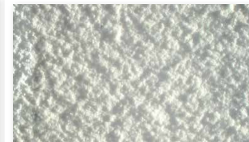
Briplast Powerfill 1891 bei 20-facher Vergrößerung (ungeschliffen)
